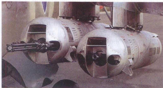
Дополнительные подвесные контейнеры с вооружением для Ми-24: слева — контейнер с одним крупнокалиберным 12,7-мм пулеметом и двумя четырехствольными пулеметами калибра 7,62 мм; справа — контейнер с 30-мм автоматическим гранатометом
