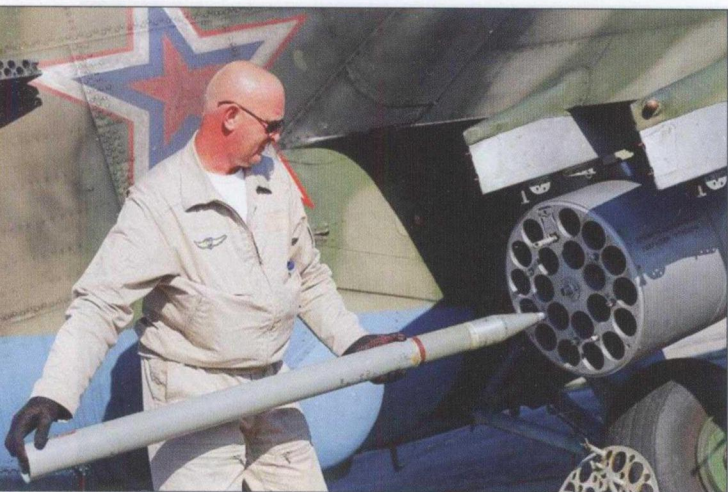
Снаряжение блока 80-мм неуправляемых ракет С-8
