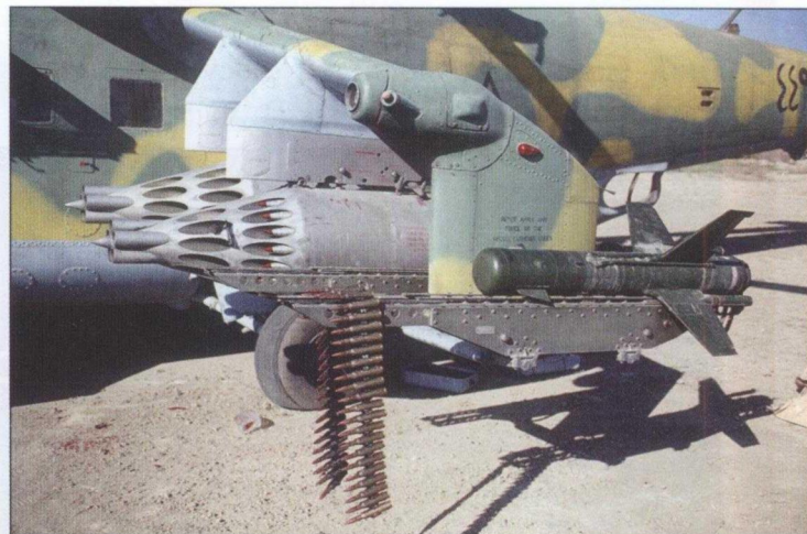
Первоначальный комплект вооружения Ми-24: управляемая ракета «Фаланга» и блоки 57-мм неуправляемых ракет. На пилоне также висит патронная лента к бортовому пулемету
