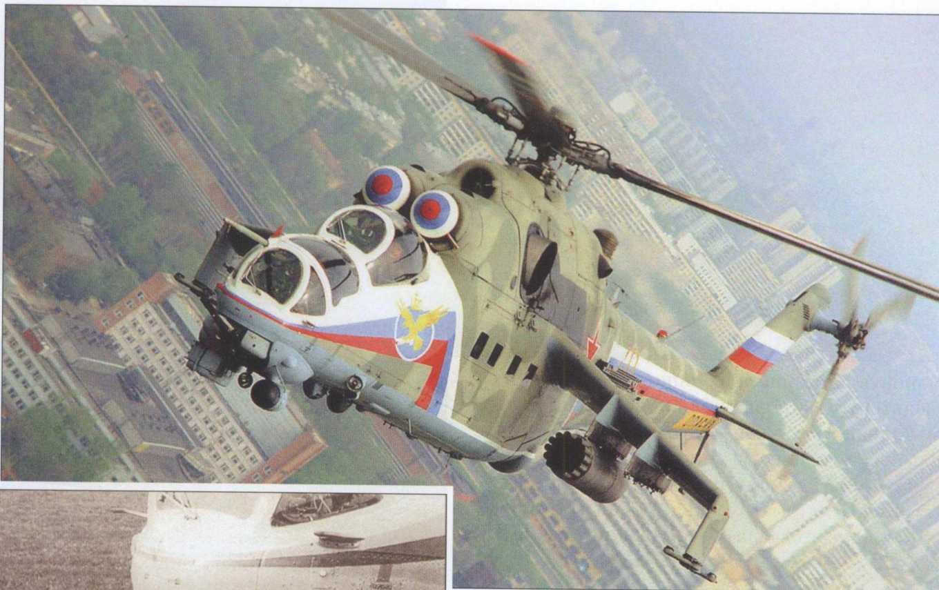
Вертолет Ми-24ВП, вооруженный спаренной 23-мм пушкой ГШ-23Л в подвижной носовой турели
