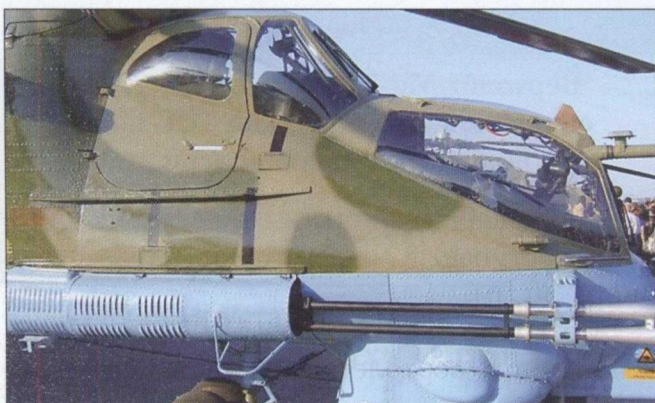
Установка 30-мм двухствольной пушки ГШ-30 на борту Ми-24П
