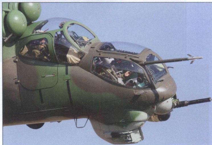
Вид на носовую часть самого массового вертолета Ми-24В. Впереди кабина стрелка, за ней – кабина пилота. В носовой части на подвижной турели установлен крупнокалиберный четырехствольный пулемет, рядом прицельный комплекс для наведения управляемых ракет
