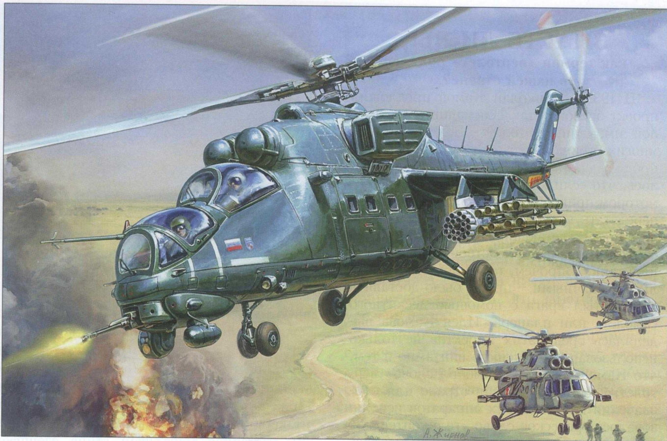
Вертолет Ми-35М в составе ВВС России. Внешне новую модификацию вертолета можно отличить по неубирающимся стойкам шасси и Х-образному хвостовому винту (вместо трехлопастного на обычных Ми-24)
