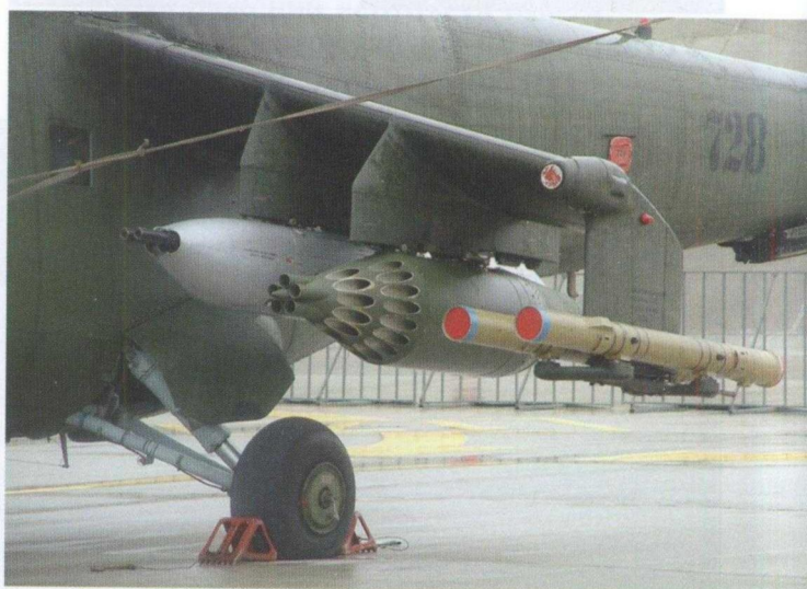
Под крылом Ми-24В подвешены два контейнера с противотанковыми ракетами «Штурм-В», блок с неуправляемыми ракетами и пушечный контейнер с 23-мм пушкой ГШ-23Л
