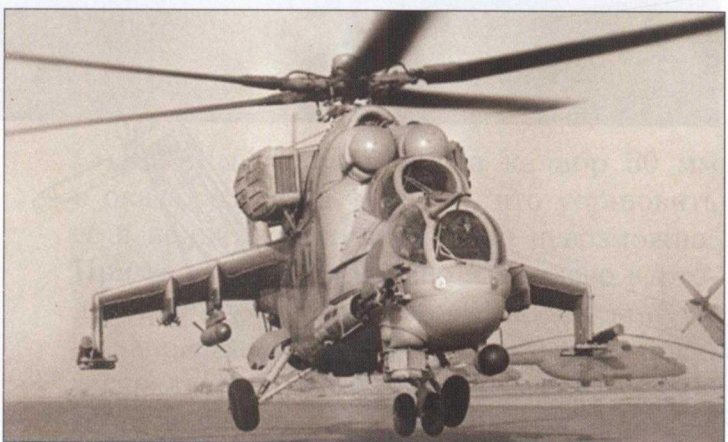
На внутреннем пилоне Ми-24П подвешена 240-мм неуправляемая ракета С-24
